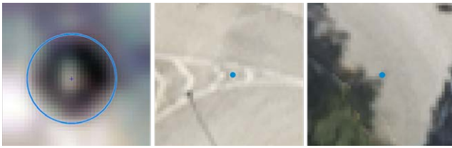
Abb. 1: Kanaldeckel-Passpunkte im DOP: (links) mit detektiertem Kreis im vierfach überabgetasteten Bild sowie (mittig und rechts) überlagert von Straßenmarkierungen bzw. dem Schatten von Bäumen und daher nicht als solche erkennbar.
