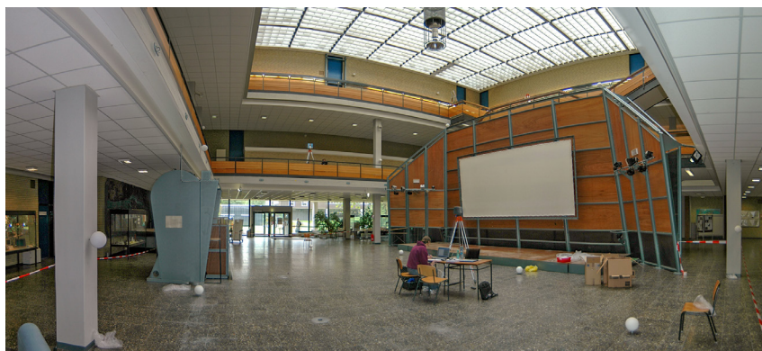
Abb. 8: Altes 3D-Testfeld der HafenCity Universität Hamburg für geometrische Untersuchungen terrestrischer Laserscanner (Campus City Nord)
