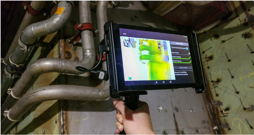
Abb. 10: Handscanner DotProduct DPI-8 im Einsatz auf der MEYER WERFT
