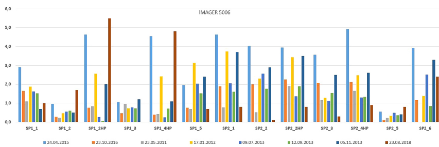
Abb. 6: Schrägstreckendifferenz zwischen erster und zweiter Lage des IMAGER 5006
