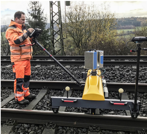
Abb. 3: Kinematisches Gleismesssystem SiTrack:One
