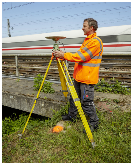
Abb. 2: Referenzpunkt mit GNSS-Empfänger
