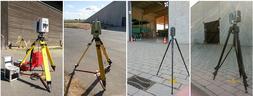
Abb. 1: Terrestrische Laserscanner während der Messung in Klein-Altendorf, von links: Leica HDS6100, Leica ScanStation P20, Leica BLK360, FARO Focus 3D X130
